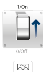
Abb. 7 Einschalten der Pumpe
