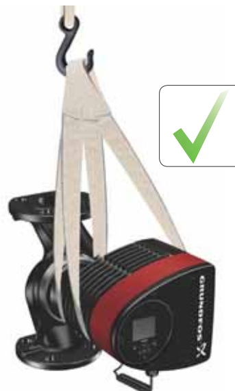
Abb. 1 Richtiges Anheben der Pumpe
